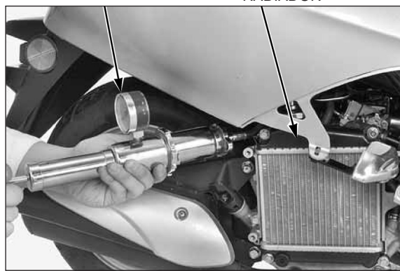
DISPOSITIVO DE TESTE DA TAMPA DO RADIADOR
